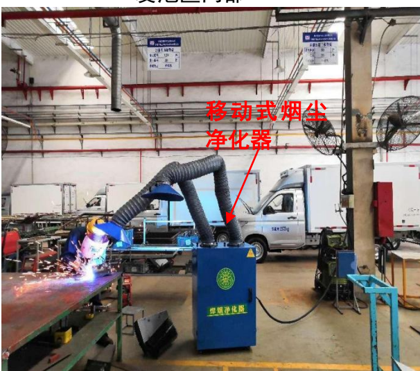
焊接、打磨工序生产区及移动式烟尘净化器
