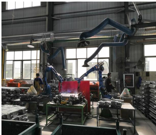
4#生产车间焊接机器人及集气罩
