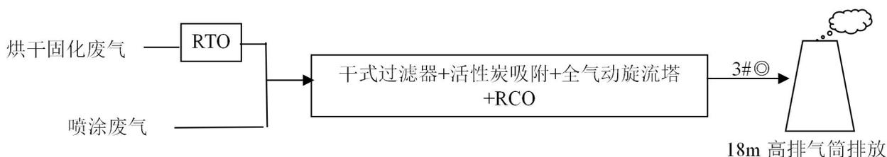
图 4.2-3 喷涂废气、烘干固化废气处理工艺及监测点位图
