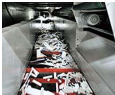
模切自动排废系统，废弃收集循环系统
